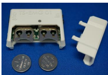
図 13 脳波用アンプ TS-EEG01 内部
