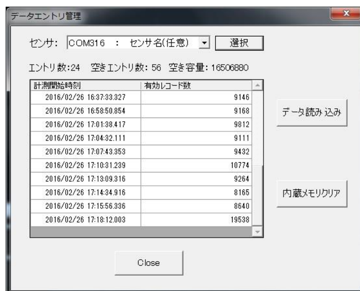
図 15 センサーを選択した後のメモリダウンロード画面
